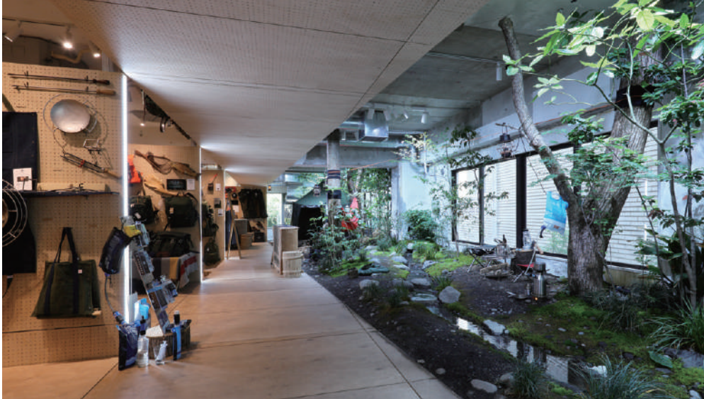
朝 (10:25～12:55) 物販エリア：色温度3000K 調光率100% 自然エリア：色温度10000K 調光率100%で朝の光を再現
