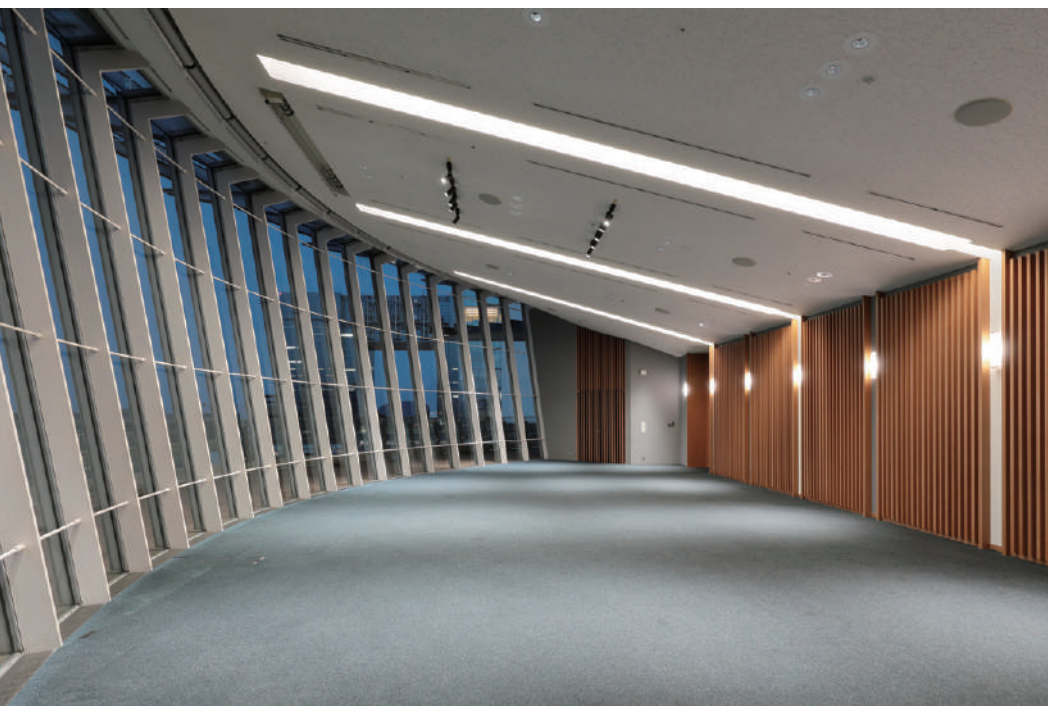
朝 天井間接照明：色温度4500K 調光率100% ダウンライト：色温度4500K 調光率100%
