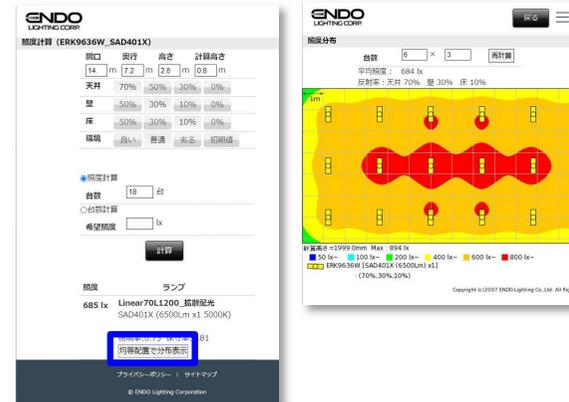
**均等配置で分布表示** をタップすると簡易照度分布図が表示されます。
