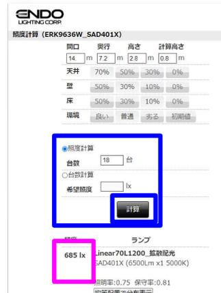
器具台数又は希望照度を入力し、**計算** をタップします。計算結果が更新されます。
